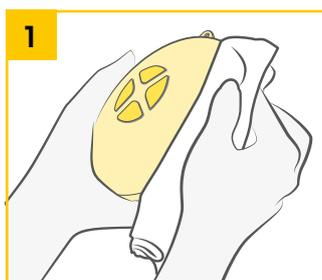
Para **limpar** a unidade do motor, limpe o corpo com um pano limpo e humedecido (não molhado). Pode usar água potável e um detergente básico ou não abrasivo.
