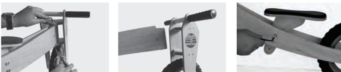
1. Com a chave allen e o auxílio de um alicate, solte o parafuso do eixo do guidão e retire-o.
